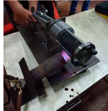
Gambar 4. 3 Pengujian dengan pemanasan pada salah satu sisi silinder mesin
